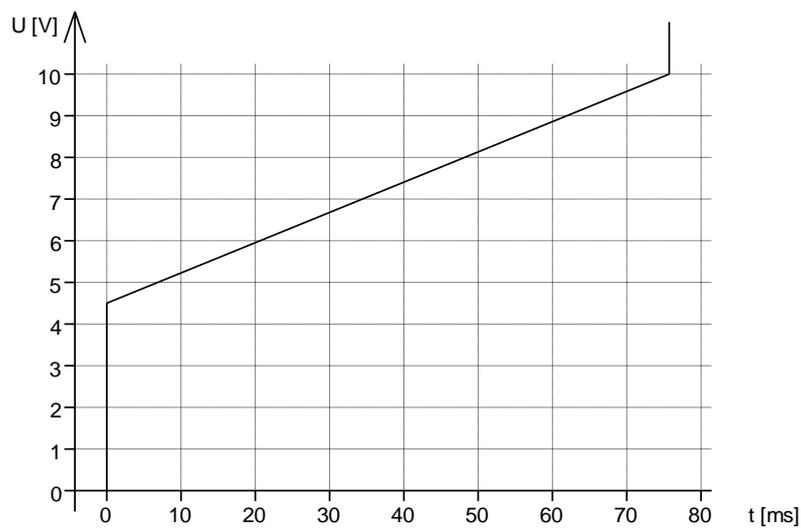
**Abbildung 10 - Rampenzeit als Funktion der Steuerspannung (JP6 gesteckt)**
