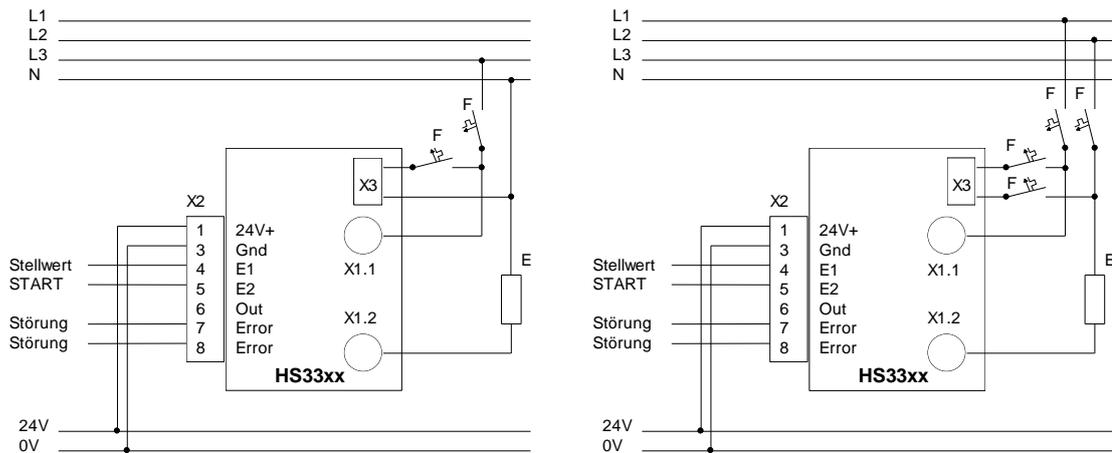
**Abbildung 7 - typischer Anschluss 230V / 400V**
