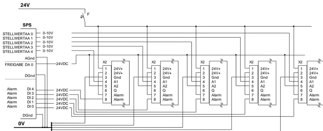
**Abbildung 11 - Ausführung mit individueller Alarm-Auswertung**
