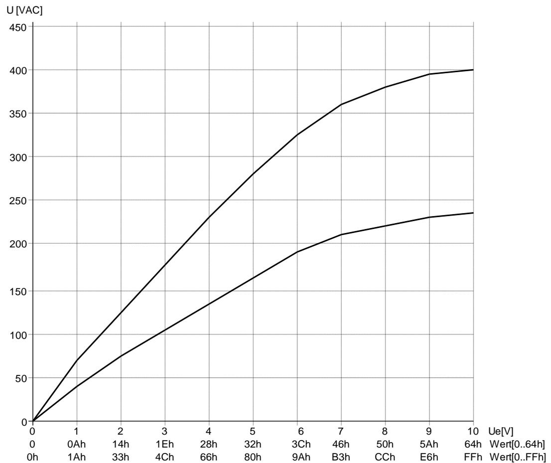
**Abbildung 10 - Effektive Lastspannung via Steuerspannung**
