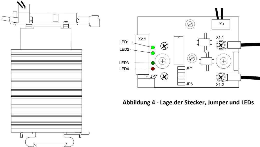
Abbildung 4 - Lage der Stecker, Jumper und LEDs
