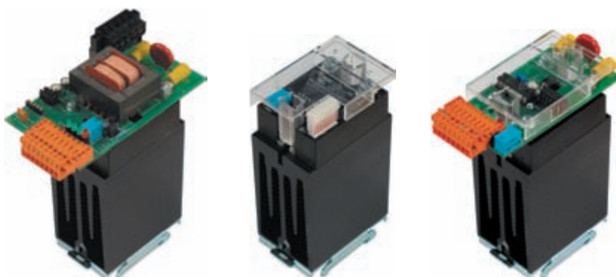
Das »UP«-Modul bietet integrierte Effektivwert-Messung mit Nachregelung.
